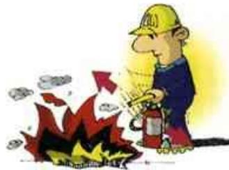
2.- Si el incendio es de proyección horizontal, barrer de forma ininterrumpida de un lado a otro de su superficie, comenzando por el borde más cercano (por ejemplo en el caso de un derrame de combustible líquido).
