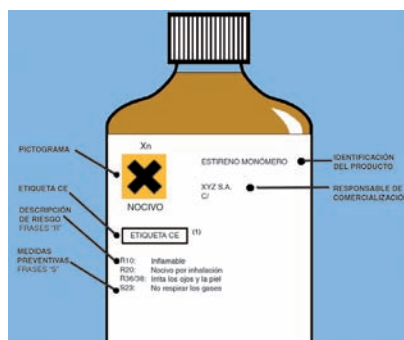
Figura 49 - Contenido de la etiqueta de sustancias químicas peligrosas.
