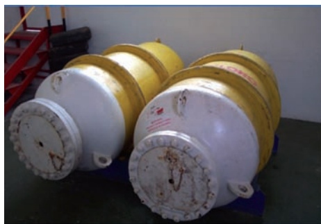
Figura 41 - Cilindros de cloro gaseoso.
