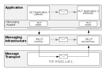
Dejando como base el nivel de transprte a TCP/IP se permite a las aplicaciones escoger los siguientes protocolos:
