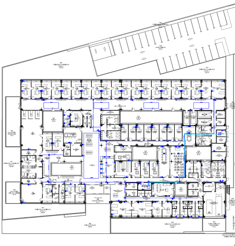
Imagen Nº 7: Canalización hacia arquetas de operadores y hacia el cuarto principal de comunicaciones
