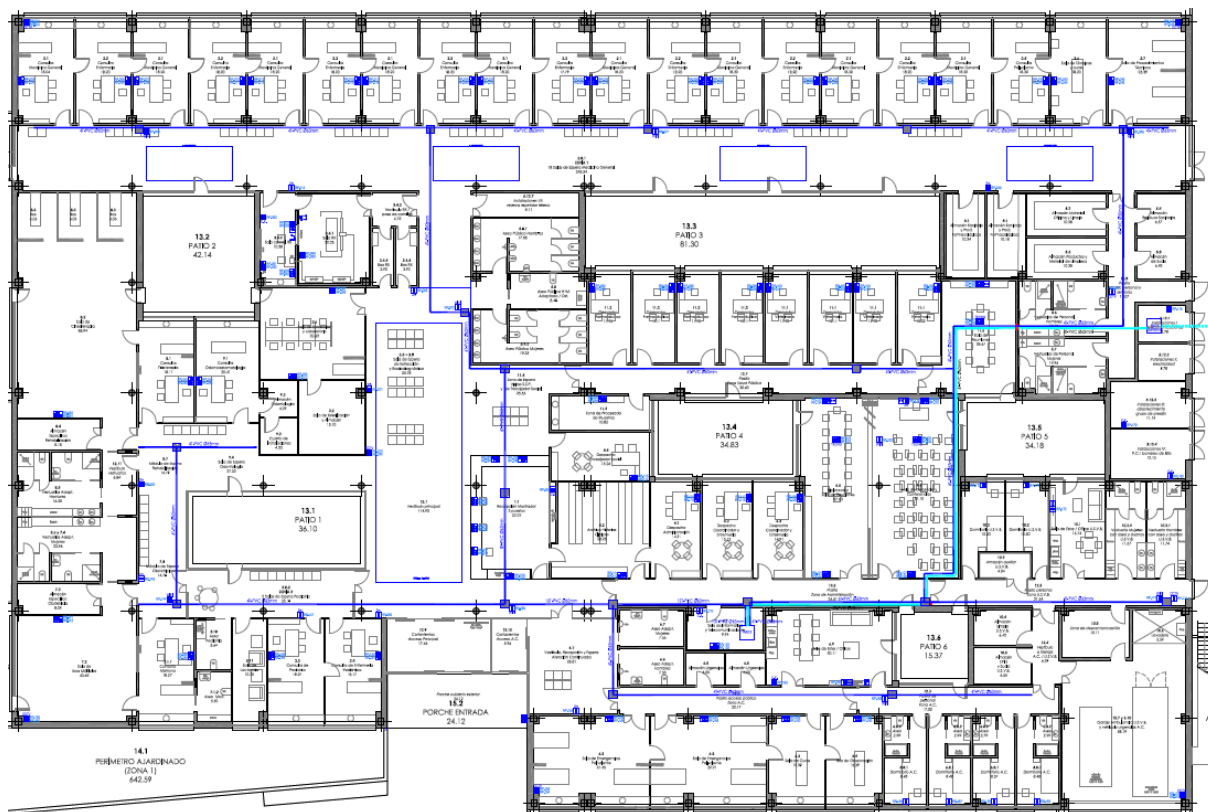
Imagen N° 3: Canalización propuesta para unión entre racks y distribución en Planta
