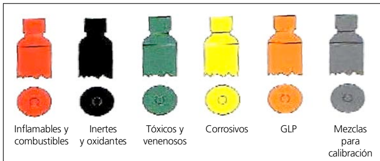
Colores de las botellas para gases industriales.
