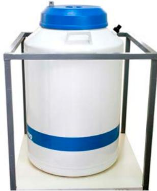
Tanque de nitrógeno líquido
