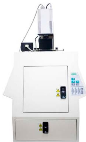
Fx-Pro Plus: Detecta radiactividad, similar a un Phosphoimager. También detecta fluorescencia en geles o blots. Dispone de dos láser, de 532 y 635 nm.
